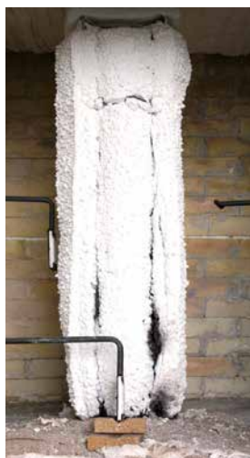
Belka stalowa po próbie ogniowej.
